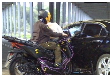
開発中のエアバッグの衝突試験の様子
